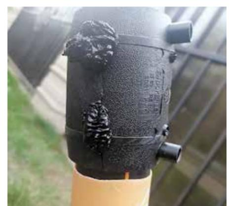
Сварка бракованной муфтой с закладным нагревателем
