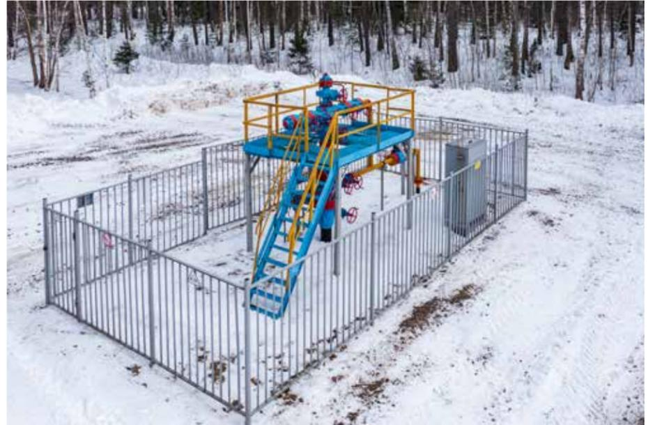
Одна из эксплуатационных скважин Калужского ПХГ, где был опробован метод увеличения производительности за счет расширения призабойной зоны пласта-коллектора
