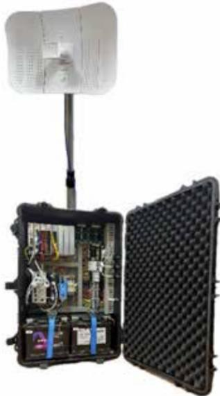
щадке, — макет системы моделирования на базе комплекса «Волна», а также мобильный комплекс дистанционного контроля и управления трубопроводной арматурой. В его состав включены две камеры видеонаблюдения во взрывозащищенном исполнении для визуального контроля за удаленной перестановкой трубопроводной арматуры при выполнении газоопасных работ.
