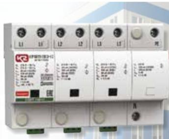
УЗИП серии K2P СВР25 изготовлены на основе оксидно-цинковых варисторов и газонаполненного разрядника, включенных в полюсе последовательно, классифицируются как УЗИП класса испытаний I+II+III.
